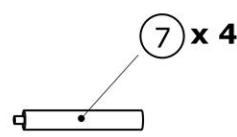
$\varnothing 20 \times 110\text{mm}$
