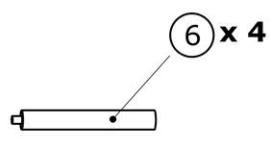
$\varnothing 20 \times 140\text{mm}$
