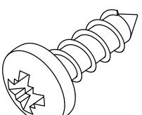
$\varnothing 4 \times 13 \text{ mm}$
