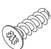
$\varnothing 4,2 \times 13 \text{ mm}$
